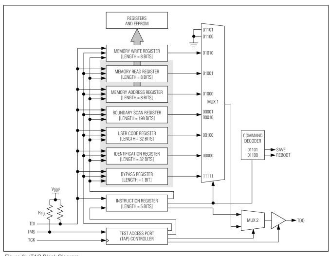
Figure 6. JTAG Block Diagram
